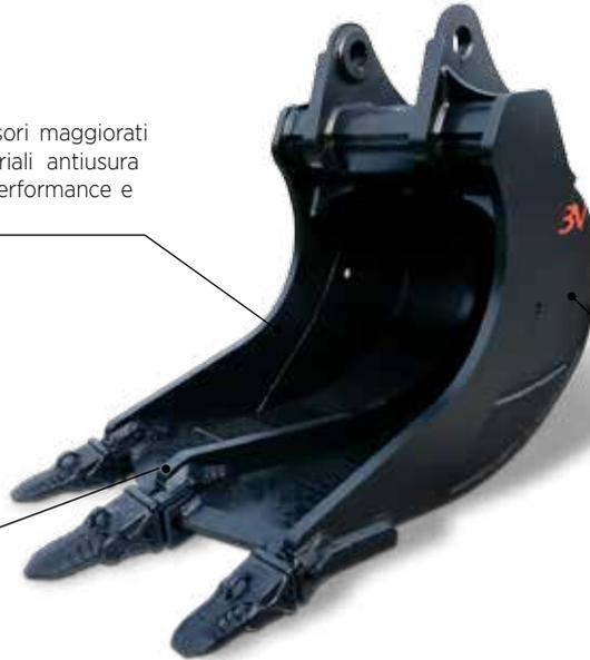
Benna concepita per impieghi gravosi, impiegata per lavori di estrazione in cava, su terreni duri e compatti, permette di smuovere i blocchi e movimentarli una volta separati dalla superficie rocciosa. Il profilo della struttura aiuta il trattamento dei materiali più resistenti e abrasivi, concentrando la forza di penetrazione sulla punta del dente.
