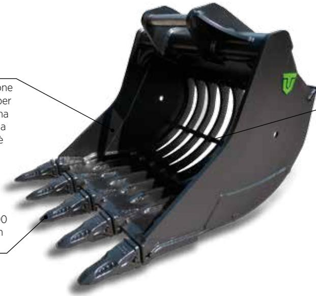
Tutte le griglie vengono saldate singolarmente su un piano di rinforzo e fissate tra loro con dei segmenti longitudinali per garantire solidità alla struttura.
